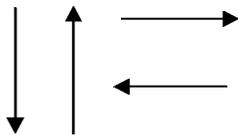
Indican la dirección de flujo en un diagrama, además conecta todos los símbolos del diagrama
